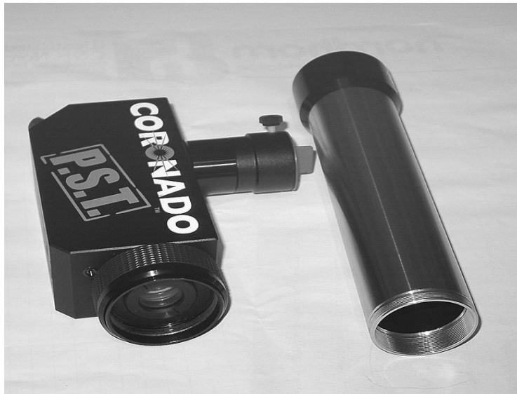
Das PST mit abgeschraubten goldfarbenen Objektivrohr
